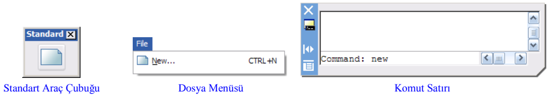
Resim 5.3: Yeni dosya açma (New File) komutunun çalıştırılma şekilleri
