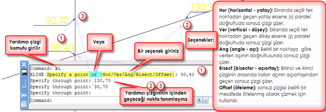
Resim 2.43: Yardımcı çizgi çizme (Construction Line) komutunun çalıştırılması
