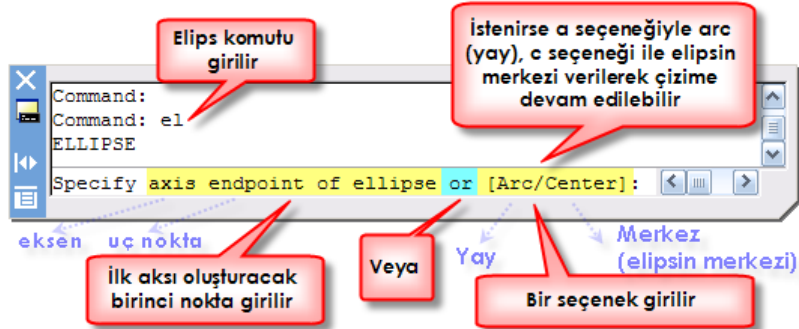
Resim 2.25: Elips (Ellipse) komutunun çalıştırılması
