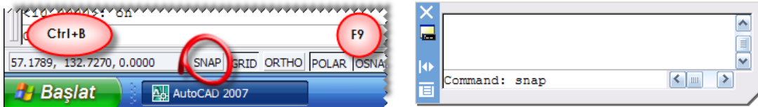
Resim 3.4: Sekme (Snap) komutunun çalıştırılma şekilleri
