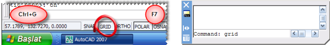
Resim 3.1: Izgara (Grid) komutunun çalıştırılma şekilleri
